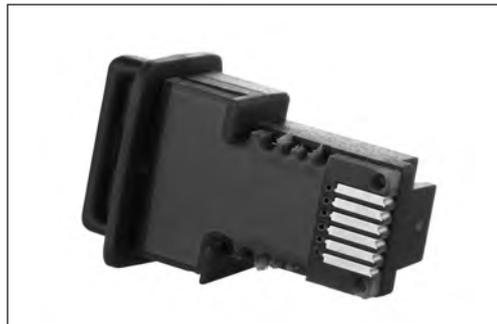
Электронный ключ программирования приложений A231 и A331 — устройство, предназначенное для обеспечения работы универсального регулятора температуры ECL Comfort 210 или ECL Comfort 310 по управлению оборудованием одной системы отопления, присоединенной к сетям централизованного теплоснабжения по независимой схеме. Ключи приложений позволяют управлять спаренными циркуляционными насосами и системой подпитки.
