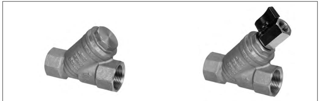
Фильтры латунные сетчатые применяются в системах холодного водоснабжения, отопления и горячего водоснабжения для защиты арматуры. Сетчатые фильтры улавливают инородные включения рабочей среды, такие как обломки шлака или капли от брызг, образованные при сварке, металлическая стружка, песок и т.д.
